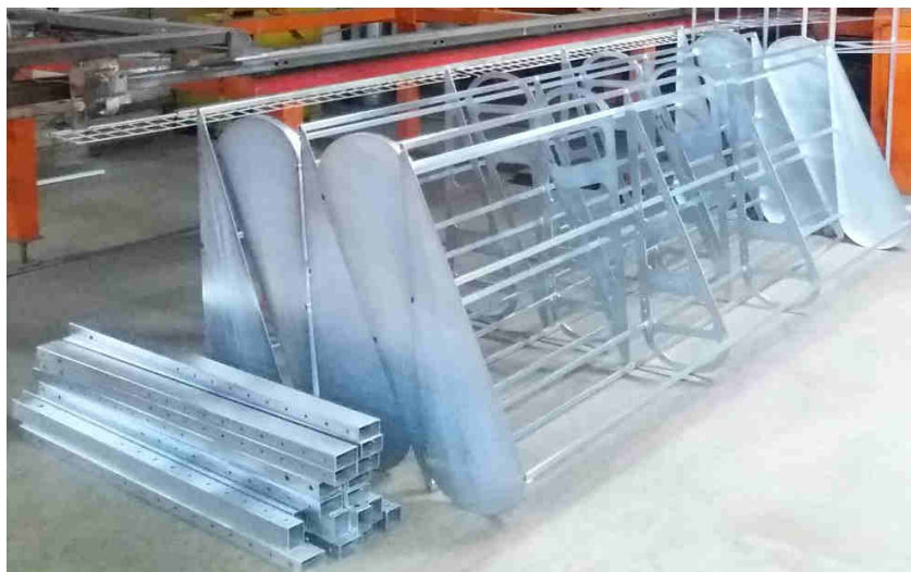
Figura 6. Structura de rezistenta a palelor turbinei eoliene
