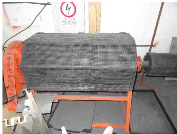
Fig. 23. Operație de vibrofinisare prin care se realizează ecruisarea superficială a pieselor utilizată de ROLIX IMPEX SERIEX SRL
