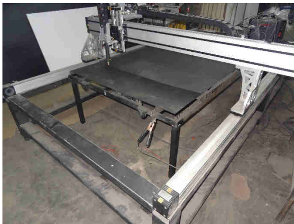
Fig. 19. Mașină de tăiat cu flacăra oxigaz utilizată de ROLIX IMPEX SERIEX SRL
