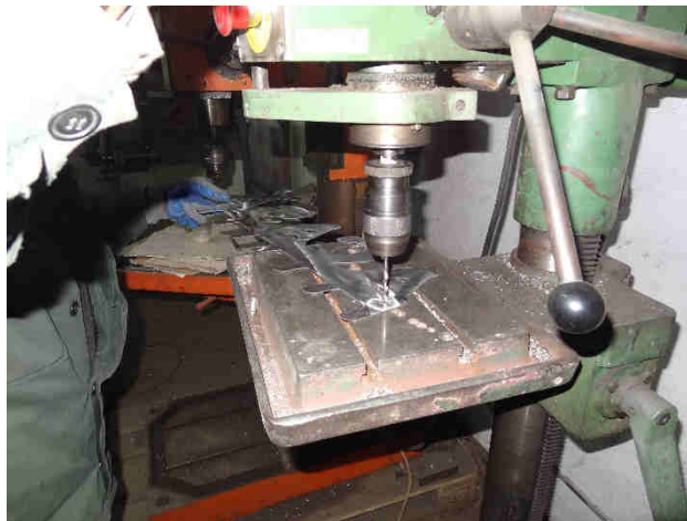
Fig. 21. Găurirea pieselor semifabricat utilizată de ROLIX IMPEX SERIEX SRL
