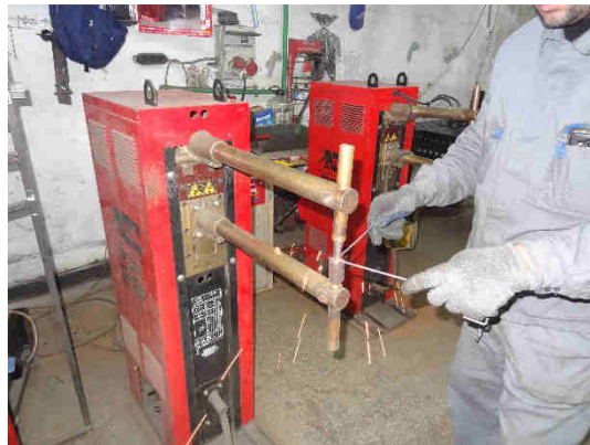
Fig. 24. Sudarea electrică prin presiune utilizată de ROLIX IMPEX SERIEX SRL
