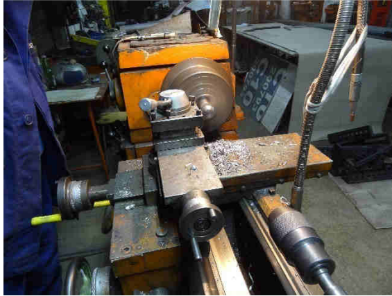
Fig. 20. Strunjirea pieselor semifabricat utilizată de ROLIX IMPEX SERIEX SRL
