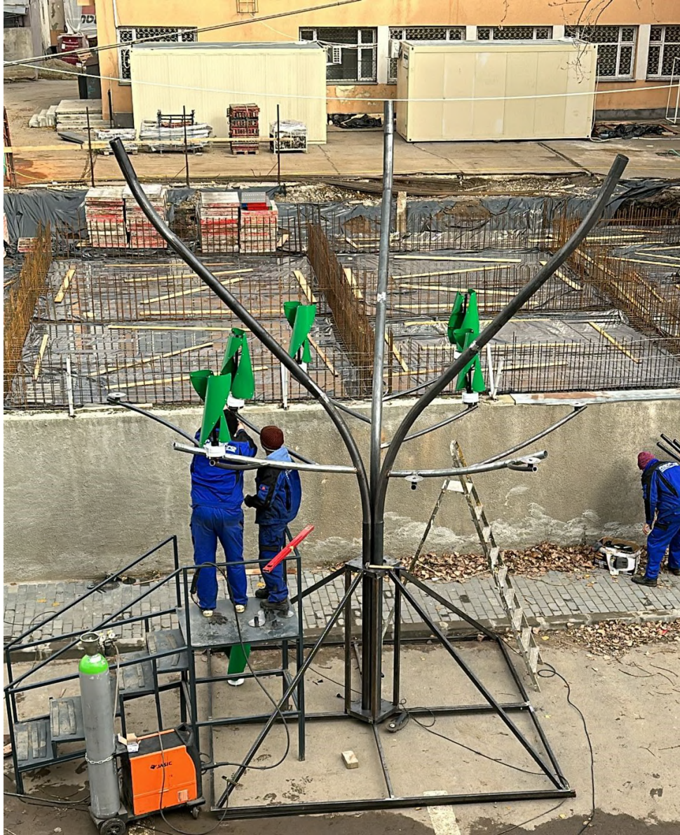
Figura 35. Prototipul de turbina eoliana de tip copac
