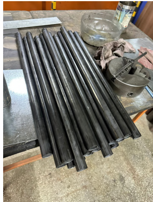
Figura 13. Cele 27 de axe pentru turbinele eoliene ce vor forma structura de copacel
