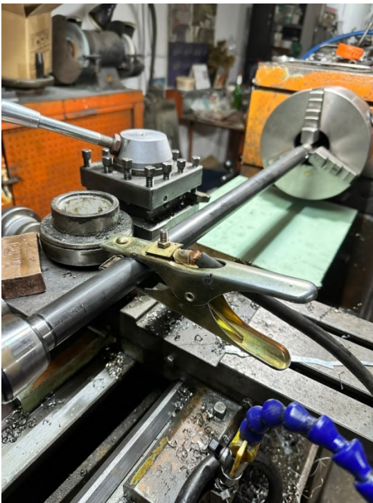
Figura 12. Prelucrarea axului de turbina eoliana
