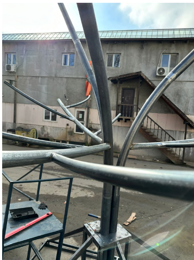
Figura 29. Subansamblu ramura secundara
