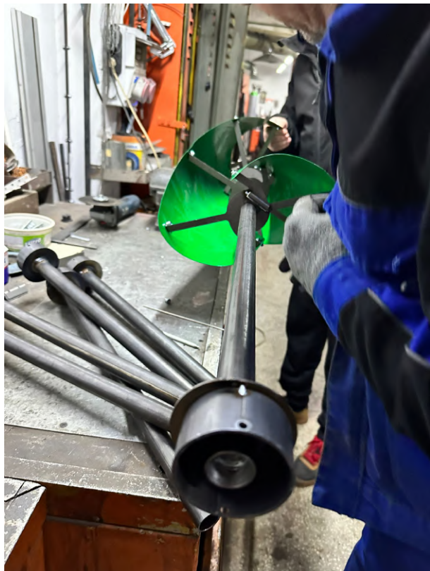
Figura 31. Ansamblarea palelor pe ax
