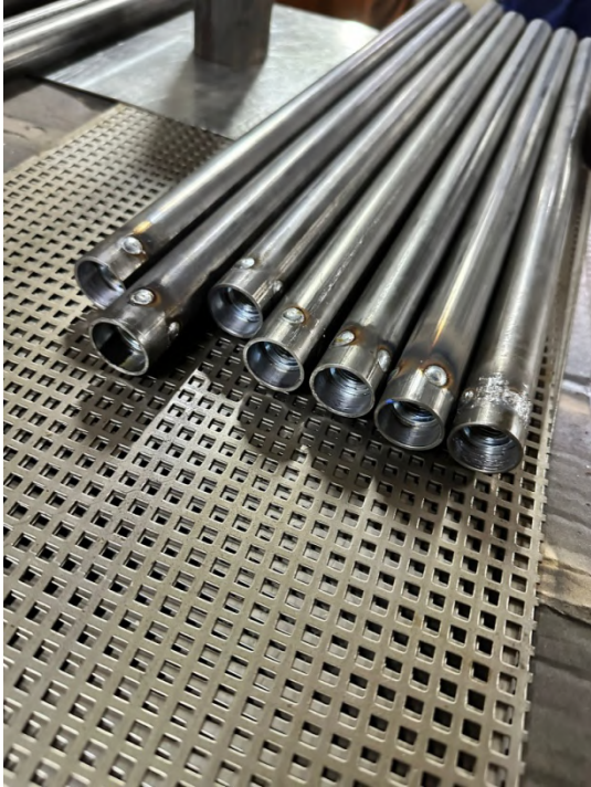
Figura 14. Prelucrarea axelor pentru conexiunea la generatoarele electrice
