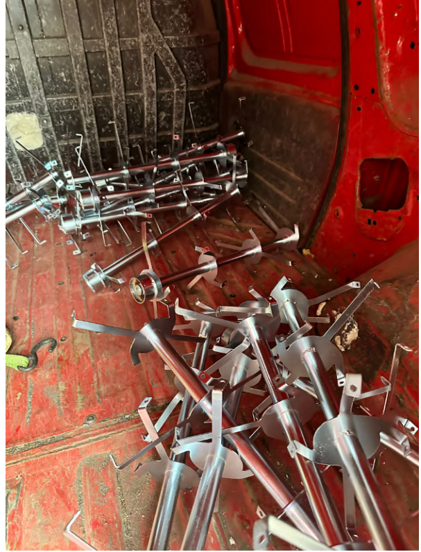
Figura 27. Axurile turbinelor dupa procesul de acoperire cu zinc
