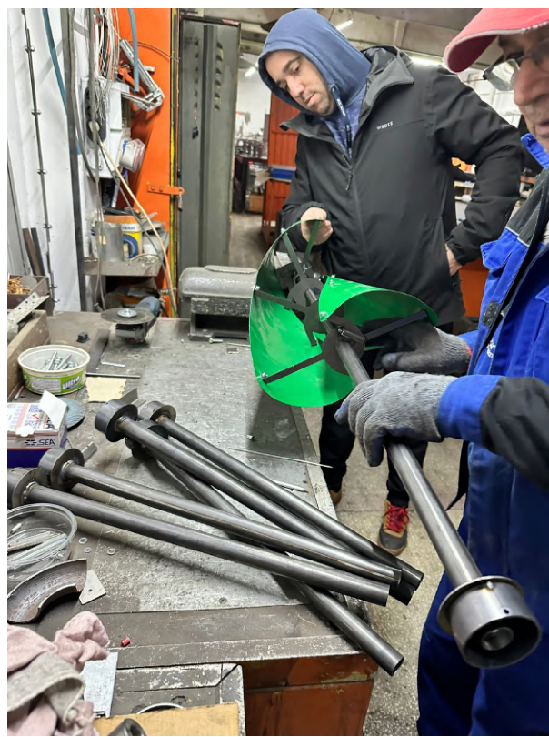
Figura 31. Ansamblarea palelor pe ax
