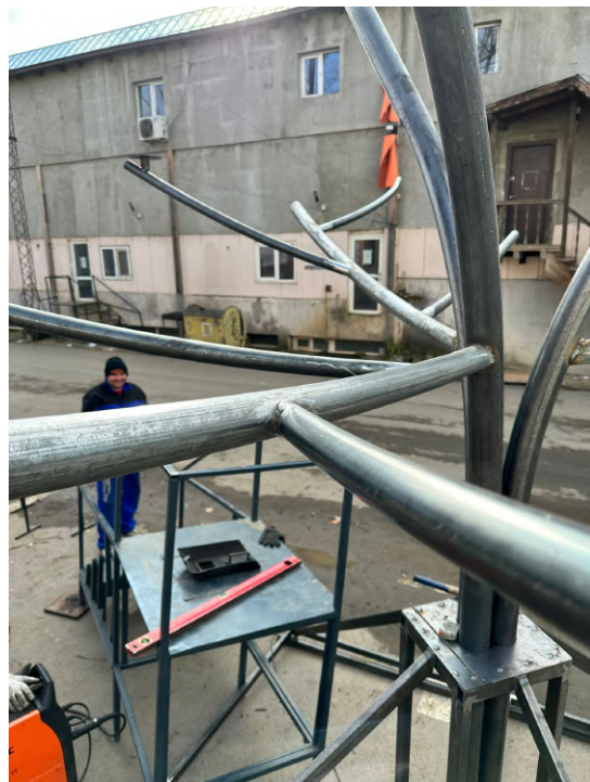
Figura 33. Asamblarea sistemului de ramuri
