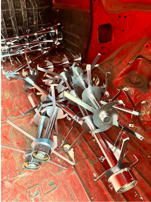
Figura 27. Axurile turbinelor dupa procesul de acoperire cu zinc
