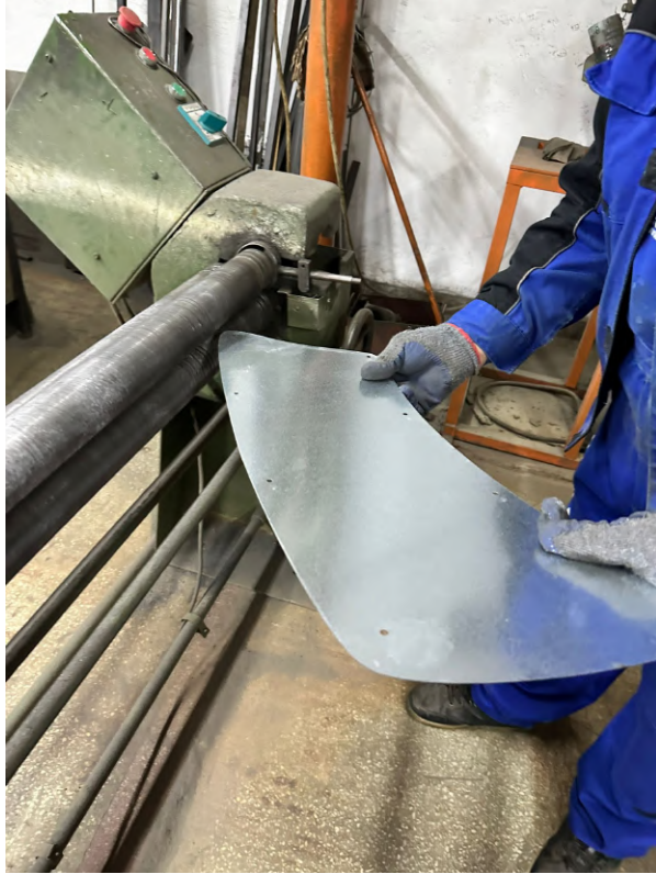
Figura 20. Prelucrarea semifabricatului de pala
