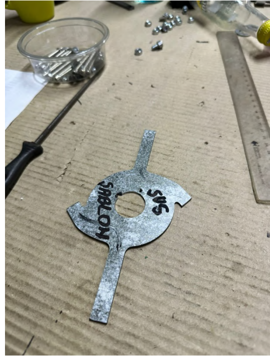
Figura 15. Sablon pentru deformarea bratelor palelor de turbina eoliana
