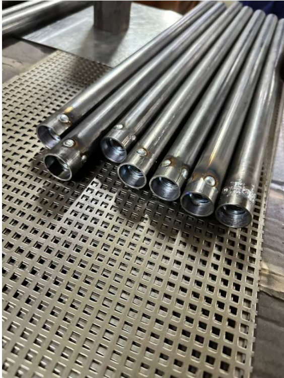
Fig. 22. Prelucrarea axelor pentru conexiunea la generatoarele electrice
