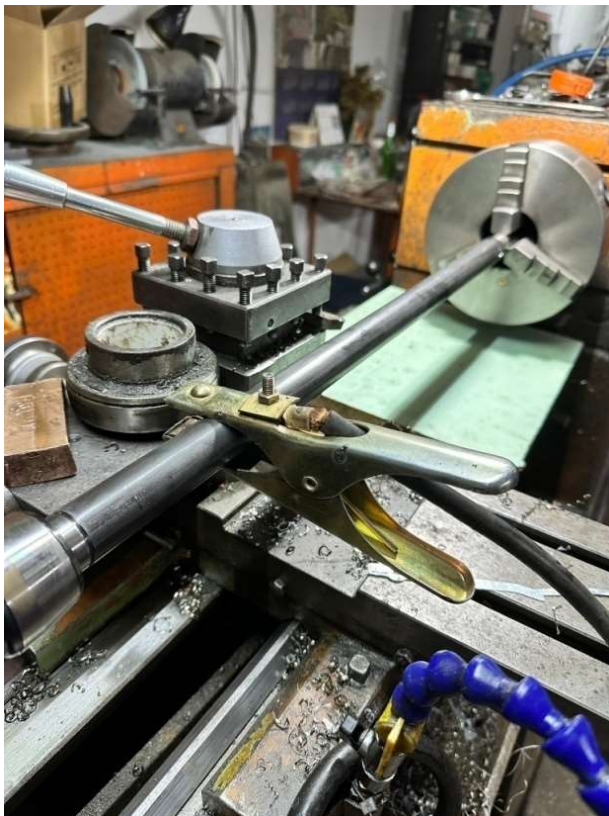
Fig. 20. Prelucrarea axului de turbina eoliana
