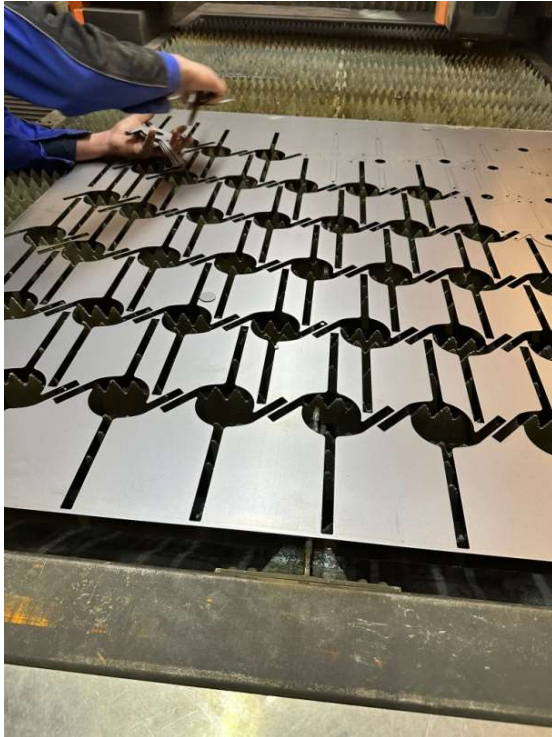
Fig. 18. Decuparea cu ajutorul laser a suportilor de pale
