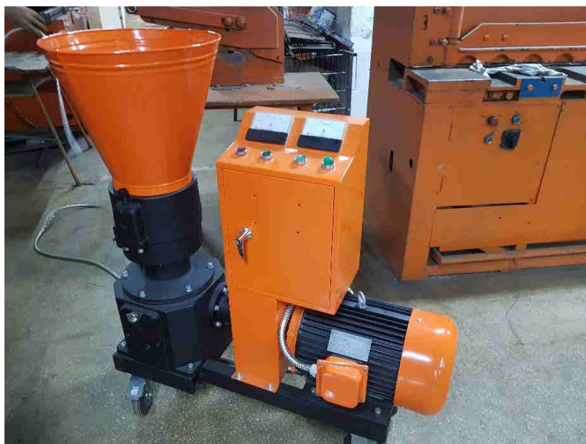
Fig. 1 Presa de peleti (15 kW)
