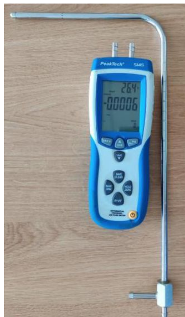
Figura 2. Manometru cu tub Pitot
