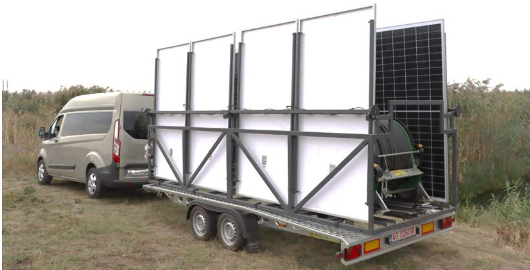
Fig. 11. Aspect din timpul deplasării în câmp a prototipului de sistem inovativ independent energetic destinat pentru irigarea culturilor agricole în condițiile actuale a schimbărilor climatice
