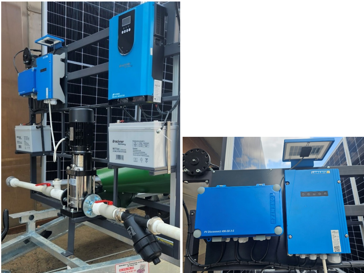
Fig. 7. Sistem de pompare pentru irigații cu pompă solară Lorentz PS2-1800 CS-F4-6 + Controller
