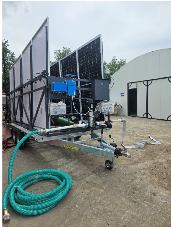
Fig. 17. Prototip de sistem inovativ independent energetic destinat pentru irigarea culturilor
