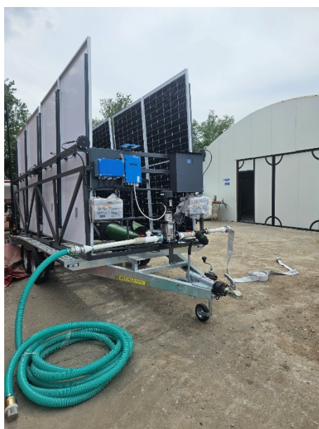
Fig. 1. Sistem inovativ independent energetic destinat irigării culturilor agricole în condițiile schimbărilor climatice actuale
