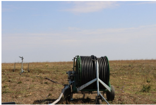
Fig. 16. Aspect din timpul măsurării vitezei de roluire a furtunului
