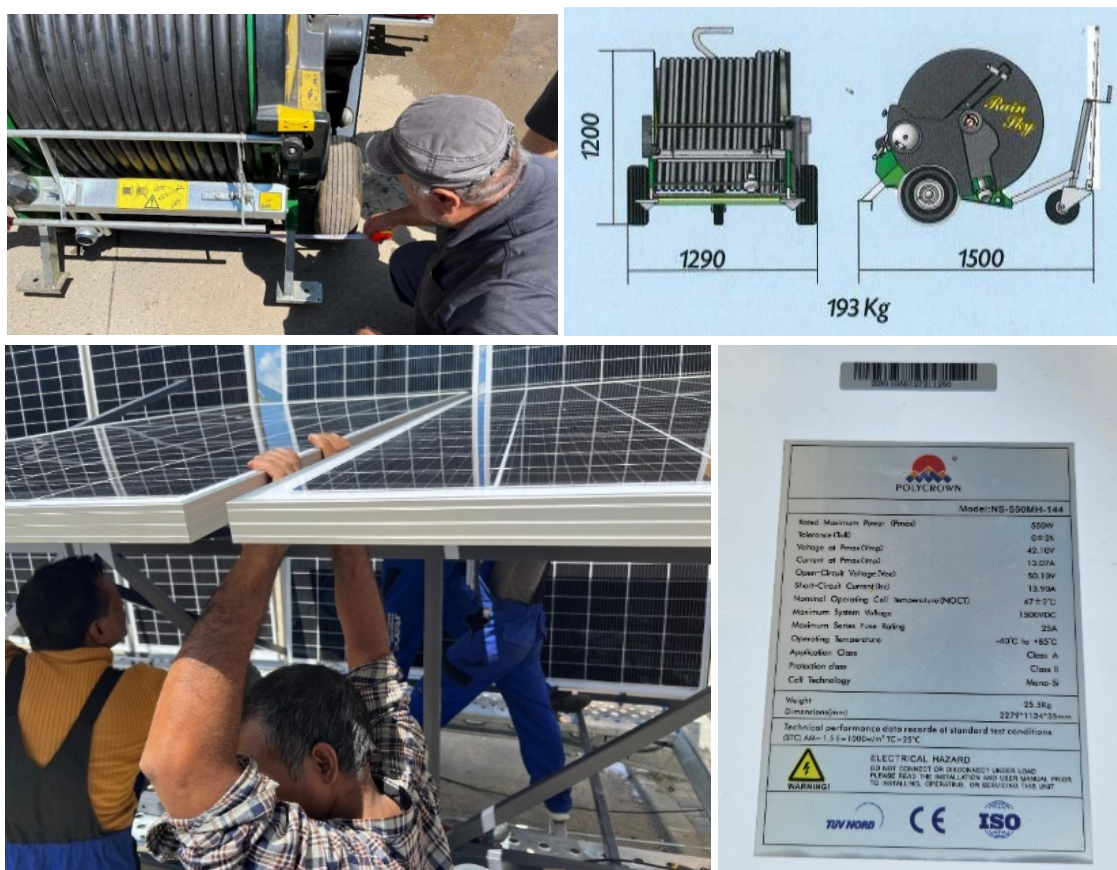
Fig. 18. Aspecte din timpul efectuării măsurătorilor dimensiunilor de gabarit și a maselor pentru compararea acestora cu cele din catalog/etichetă de produs
